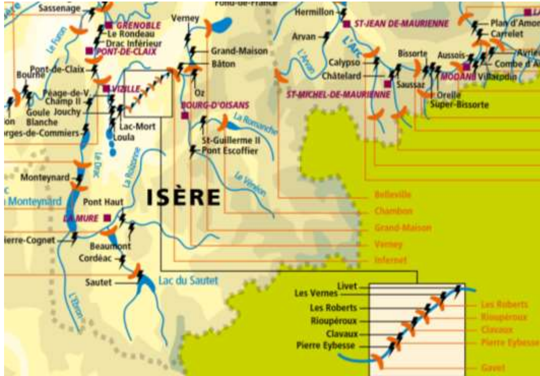
Figure 34 : Plan de situation des ouvrages hydroélectriques et des barrages, avant construction de l'ouvrage de Romanche-Gavet
